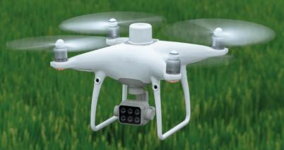
精灵 4 多光谱版是一款配备一体式多光谱成像系统的航测无人机,可采集高精度多光谱数据,助力农业监测与 环境监察工作高效完成。
